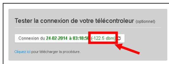
2. Le test n'est pas concluant si la date et l'heure de la dernière connexion ne correspond pas à plus de 15mn de celle à laquelle vous avez effectué le test. Dans ce cas veuillez effectuer cette série de test :
